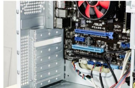
Inserire la scheda PCIe nell'apposita fessura. Controllare che la scheda sia ben inserita nella fessura. Fissare quindi la scheda con una vite all'involucro del PC.
