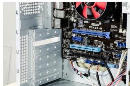
Inserte la tarjeta PCIe en la ranura prevista. Cuide de que la tarjeta tenga un asiento firme en la ranura. Fije a continuación la tarjeta a la caja del PC con un tornillo.
