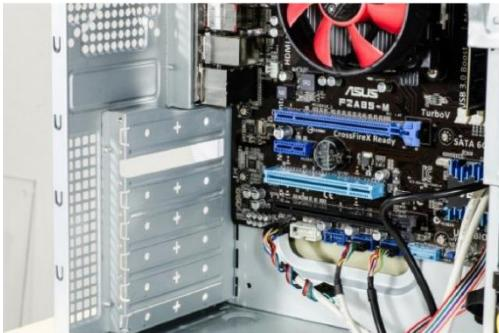
Insérez la carte PCIe dans le slot prévu. Veillez à ce que la carte soit solidement fixée dans le slot. Fixez-la ensuite à l'aide d'une vis sur le boîtier du PC.
