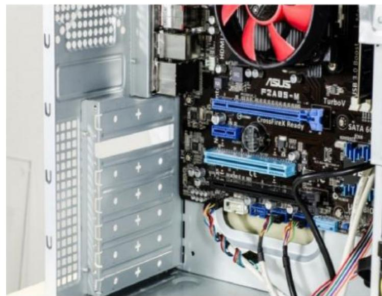
*PCI-E*カードを付属のスロットに差し込みます。カードがスロットにしっかりと挿入することをご確認ください。次に、ねじを使用して *PCI-E*カードを *PC*ホストにしっかりと固定します。
