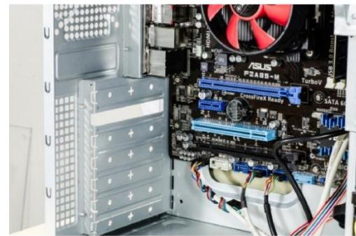
Stecken Sie die PCIe-Karte in den vorgesehenen Steckplatz. Achten Sie darauf, dass die Karte fest im Steckplatz sitzt. Befestigen Sie anschließend die Karte mit einer Schraube am PC-Gehäuse.
