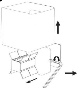
1. Retire la cubierta de aluminio de la lámpara de pared. Use la llave hexagonal incluida para quitar la base del cuerpo principal.
