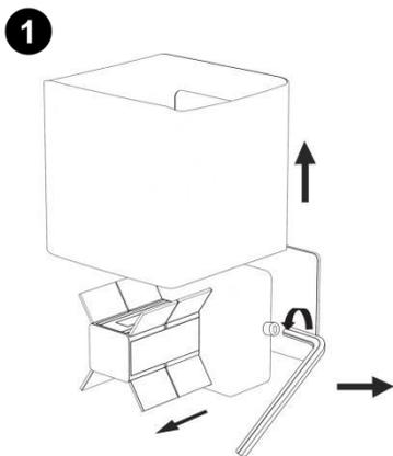
1. Entfernen Sie bitte zuerst die Aluminiumabdeckung der Wandlampe. Verwenden Sie den mitgelieferten Inbusschlüssel, um die Basis vom Hauptkörper zu entfernen.
