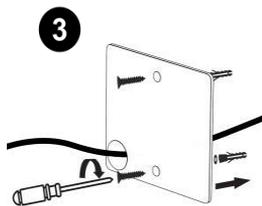
3. Infilare il filo del circuito elettrico domestico attraverso il piccolo anello di gomma della base della lampada e collegarlo alla lampada da parete.
