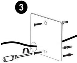
3. Taladre dos orificios en la pared y coloque los dos pernos de plástico incluidos en cada uno de los orificios, luego use los dos tornillos incluidos para fijar la base de la lámpara a la pared con un destornillador.
