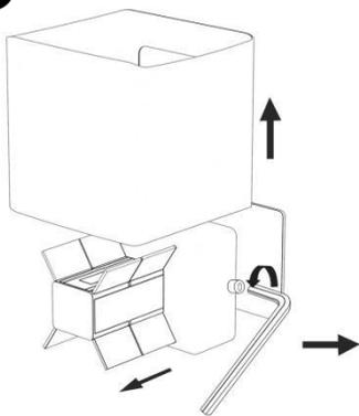
1. Retirez le couvercle en aluminium de l'appareil. Utilisez la clé hexagonale incluse pour retirer la base de l'appareil.
