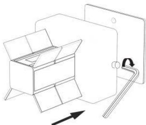
4. Fixez le corps de la lampe à la base de la lampe à l'aide de la clé hexagonale.
