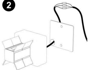
2. Branchez les fils domestiques avec les fils de la lampe murale à l' aide des bornes des fils.
