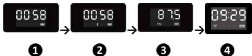
Nach dem Hochfahren dieses Produkts zeigt der Lautsprecher zunächst die Zeitkalibrierungsschnittstelle **1** an. Drücken Sie die **M**-Taste, um durch die verschiedenen Schnittstellen zu blättern, z. B. Bluetooth-Modus **2**, FM-Funktion **3**, TF-Kartenmodus **4** (verfügbar, nur wenn eine TF-Karte eingelegt ist).
